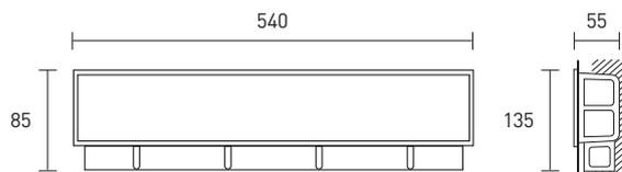
Dettagli: convogliatore di condensa posto all'interno, facilmente ispezionabile non essendo sotto traccia, permette l'allacciamento dello scarico sia a destra che a sinistra. Essendo distanziato dalla base della scatola stessa impedisce la formazione di umidità sulla parete.
